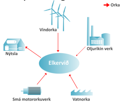
Mynd 7.2: Modell yvir hvussu elskipanin virkar í dag. Kelda: SEV.
