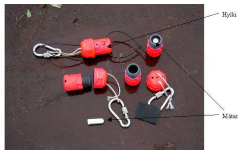
Mynd 2.1: Trýstmátarar og hylkir, sum eru gjørd til at verja mátaranar.
