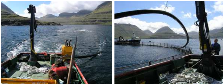
Mynd 4.1: Til vinstu: Sökkringurinn fleyt aðrenn hol var sett á hann, og verður hér sleipaður út til alibrúki. Til hægri: Sökkringurinn verður lyftur uppum aliringin.
