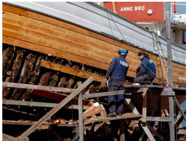
▲ Anne Bro ble bygget som seiljakt i Kristiansund i 1911. Fartøyet er trolig blant de siste jaktene som ble bygget. Anne Bro er senere ombygget til motorfartøy, men har bevart mange opprinnelige detaljer i både interiør og eksteriør. Anne Bro har tilhørt Vågan i Nordland fra 1954. Fartøyet er restaurert ved Nordnorsk Fartøyvernssenter i periodene 1999-2001 og 2004. Foto: Nordnorsk Fartøyvernssenter og Båtmuseum
