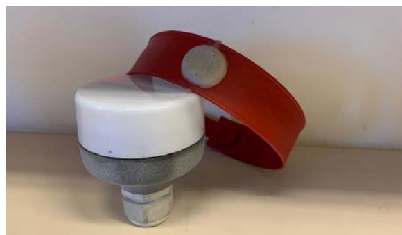
Figur 2. 2019-generasjonen av «blinklys-mottaker» (t.v.) og «senderklave» (t.h). (foto: Johannes Karlsson).
